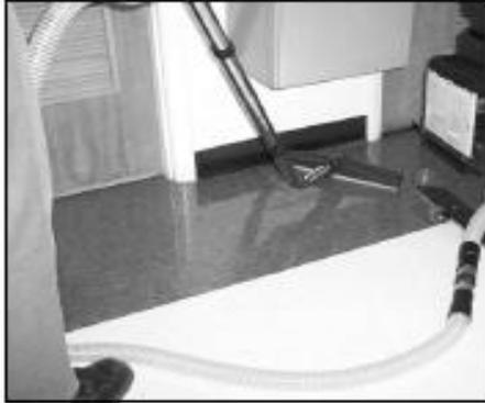
La Wrangler 2016, incluye un kit para levantar agua en lugares inaccesibles y estos accesorios se integran sobre el equipo cuando no este en uso.
