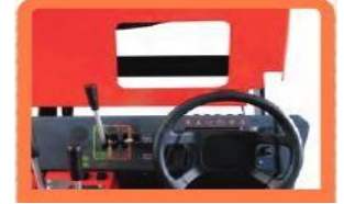
Ventana para visión de seguridad para descarga
